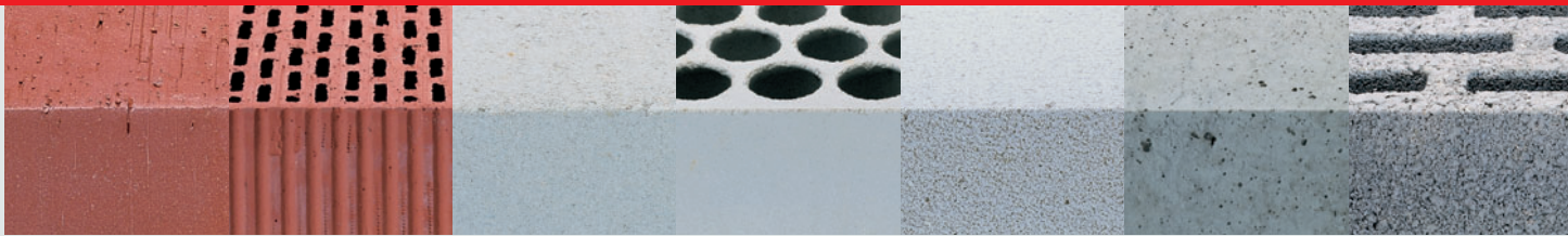
Полнотелый кирпич MZ Щелевой кирпич HLZ Полнотелый силикатный блок KS Пустотелый силикатный блок KSL Пенобетон Pв Бетон B Пустотелый блок из легкого бетона Hвп и Hbl
